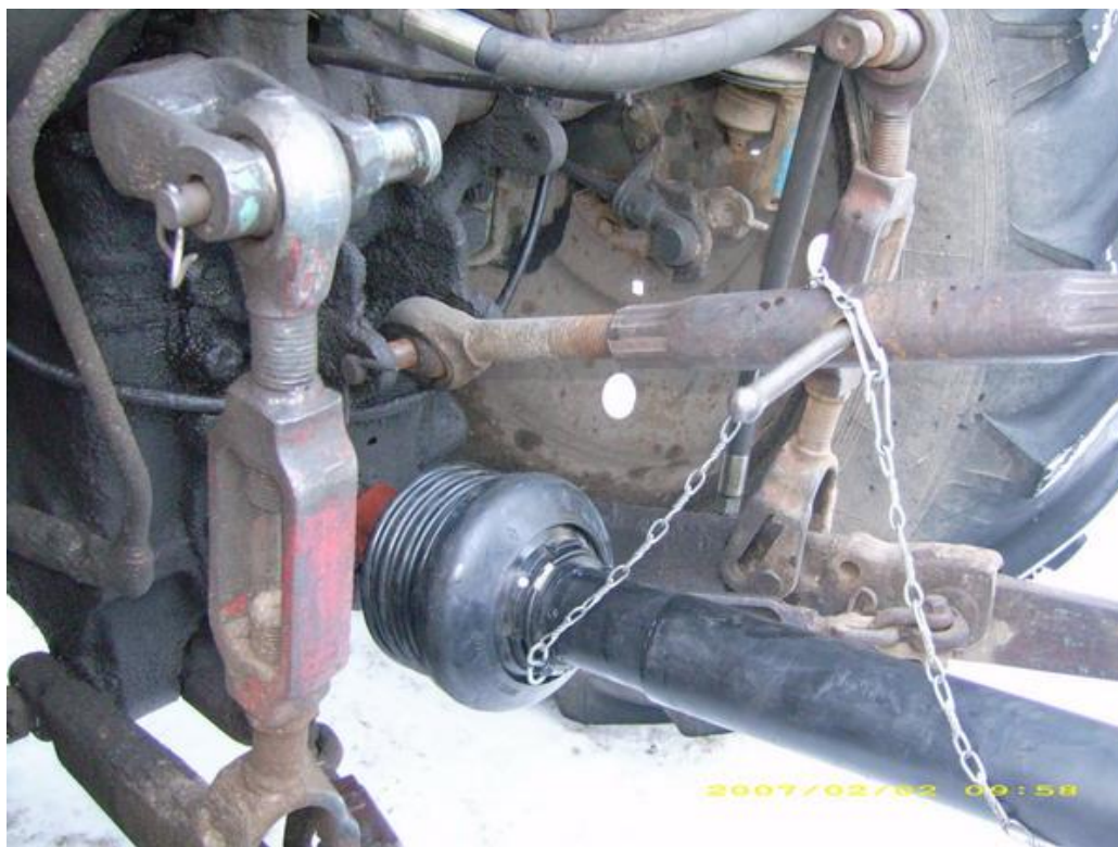
Рис. 3 – Схема крепления телескопического вала.
